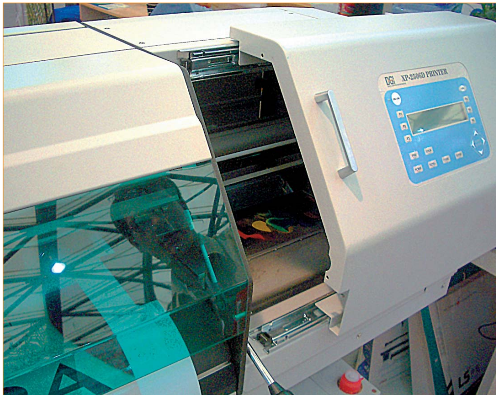
Доступ к узлу парковки блока головок принтера XP-2506D
