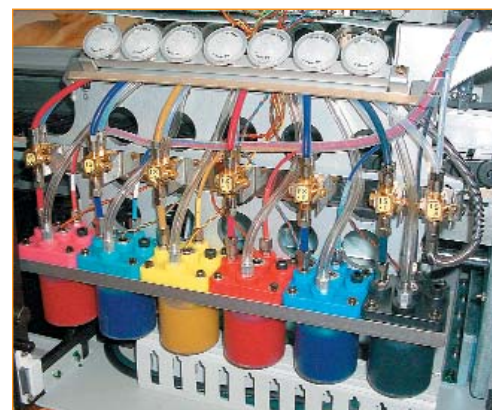
Обратная сторона блока головок принтера XP-2506 с субтанками и воздушными фильтрами
