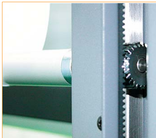
Шестеренчатая система контроля натяжения носителя с оптодатчиками
