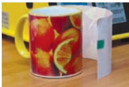
Удаление отработанной бумаги после печати (п. 9, 10)
