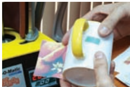
Закрепление отпечатка на кружке (п. 6)
