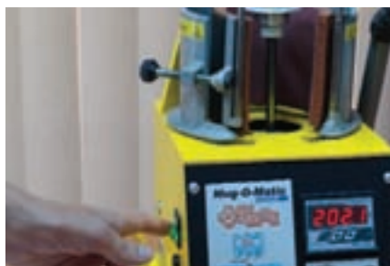
Включение термопресса (п.2)
